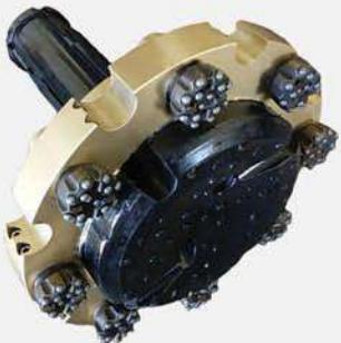
**RING BIT**: برای نخستین بار در صنعت حفاری شرکت مهندسی دقیق صنعت توانسته است با استفاده از سرمته های مستعمل سایز بالا و قرار دادن رینگ بر روی آنها قابلیت حفاری های سایز های بالاتر را ایجاد نماید . با مونتاژ این رینگ بر روی سرمته های  $1\frac{1}{2}$  مستعمل و با استفاده از چکش DS 12 امکان حفاری سایز ۲۴ اینچ و بالاتر امکان پذیر می باشد. همچنین این تکنولوژی برای تغییر و افزایش سایز حفاری در دیگر سرمته های بزرگ سایز نیز قابل تعمیم می باشد.
