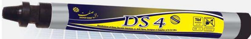
: این چکش با سرمهته های اینگر **DHD340 A** (بدون تفلون) کار میکند که در طراحی آن کلیه قطعات پلیمری حذف و مناسب کمپرسورهای فشار بالا بوده که سرعت عمل و نرخ نفوذپذیری بسیار بالا حاصل طراحی نوین در این چکش میباشد که دوام عالی و مقاومت به استهلاک قابل توجه آن حاصل استفاده از مواد اولیه مرغوب و پروسه تولید به روز میباشد. قطعات داخلی همچون سیلندر داخلی و بوش هادی در این چکش بصورت شیرینک فیت موتتاژ گردیده که حاصل آن سهولت در موتتاژ و دموتاژ وهمچنین خرابی بسیار پایین و دوام بالا در این چکش شده است.
