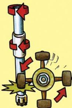
در سیستم حفاری درون چاهی (یا به اختصار DTH) ضربه زن (چکش) که با سیستم هوا به صورت پنوماتیک کار می‌کند در پایین ترین نقطه‌ی رشته‌ی حفاری و بلا فاصله پس از رادها و قبل از سرمهته قرار می‌گیردو این موضوع باعث عدم انتلاف انرژی در حین حفاری شده و در نتیجه می‌توان تا هر عمقی را بدون انحراف حفاری نمود.
